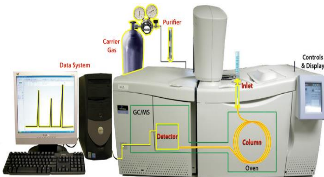
Figura 17. Esquema básico de un sistema cromatográfico. Fuente: Restek. com
