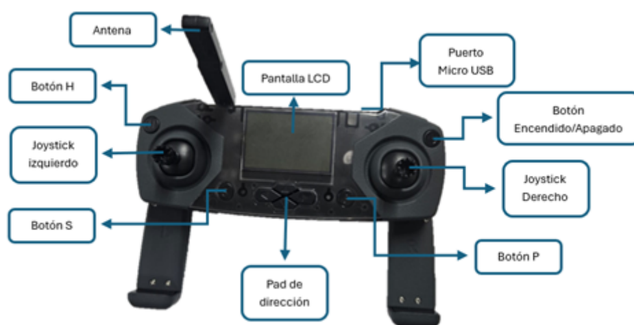
Figura 9.3: Partes importantes del control desde la vista superior.
