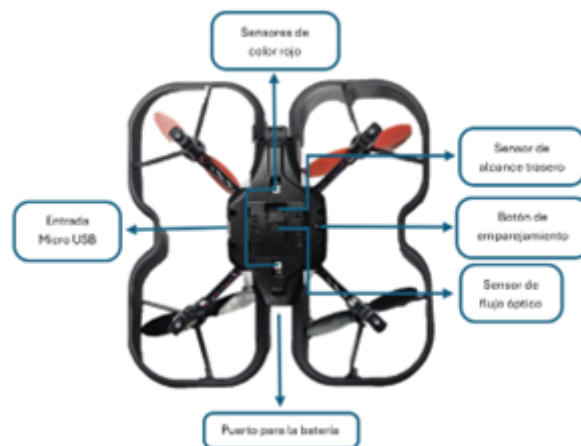
Figura 9.2: Partes de importancia del dron desde la vista inferior.
