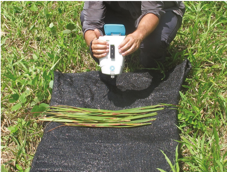
Figura 5. Obtención de la firma espectral de Palma africana ( Elaeis guineensis ) a una distancia aproximada de 15 cm, en Parrita, Puntarenas, Costa Rica.
