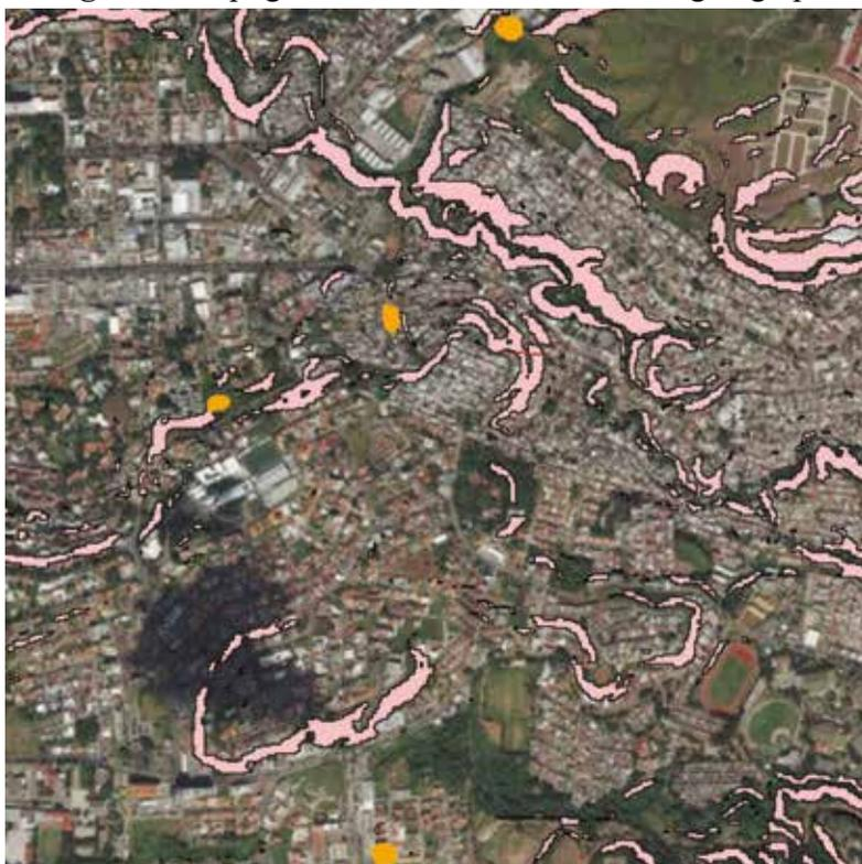
**Fuente:** CI AMBIENTAL (2013). La imagen muestra de Topografías de deslizamiento (dorado) que no coinciden con zonas de amenaza alta a movimientos de ladera (rosado)
