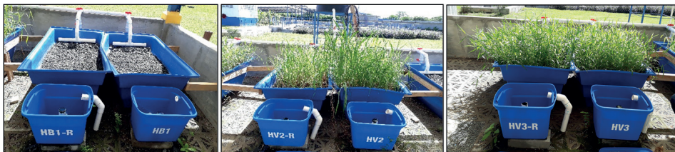
Figura 9. Módulos experimentales de humedales de flujo subsuperficial horizontal
