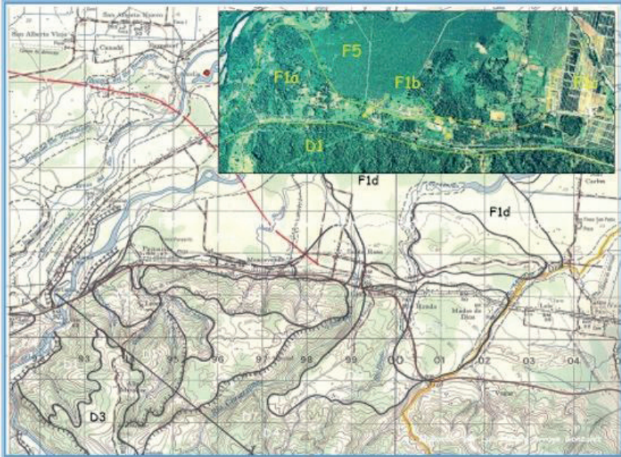
Figura No.1. Ejemplo de paso de detalle estereoscópico a mapa
