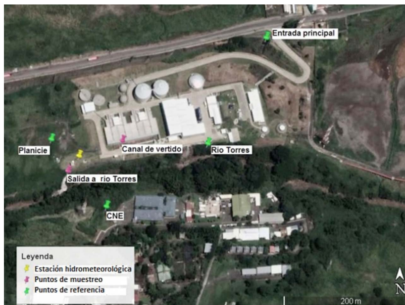
Figura 2. Estaciones de medición establecidas en la planta de tratamiento de aguas residuales en San José, Costa Rica. Nota: Fuente propia de la investigación.
