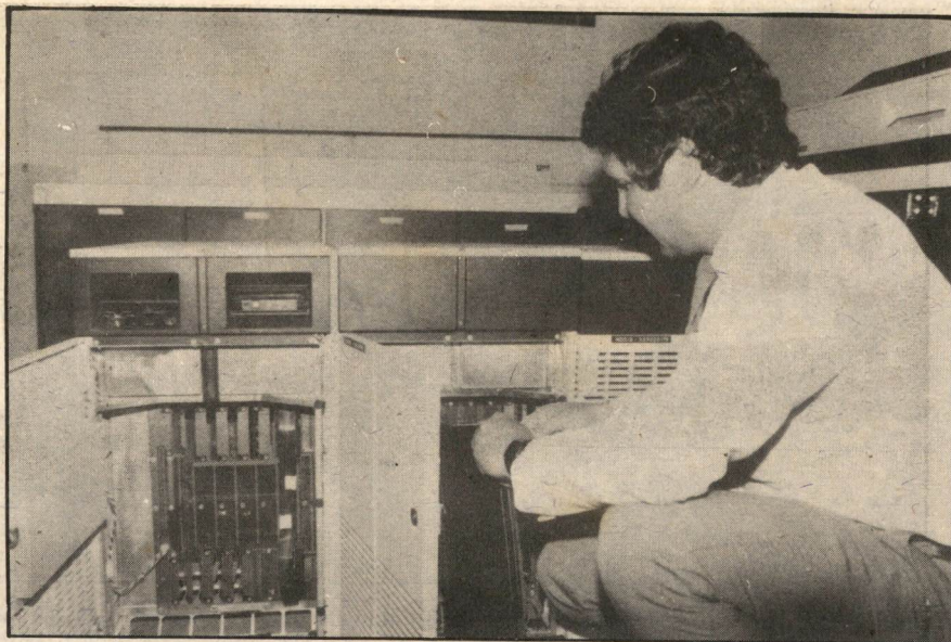
En la Sala de Operación, al lado de los laboratorios, se ha instalado el minicomputador XC 550 de la Burroughs, que trabaja con seis terminales. En la fotografía se aprecia la unidad de cintas.
