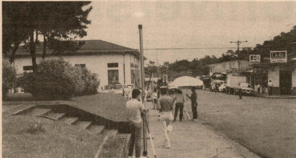
Estudiantes de la Escuela de Topografía, Catastro y Geodesia de la Universidad Nacional realizan parte de las mediciones correspondientes al control geodésico del deslizamiento de Puriscal. Este trabajo se realiza con aportes de la Comisión Nacional de Emergencia.
