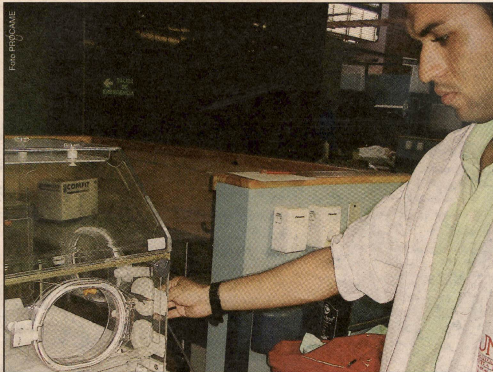
Víctor Morales Figueroa, Coordinador del Laboratorio de Metrología del PROCAME, durante la calibración de una cuna térmica neonatal Hospital de la Anexión de Nicoya.
