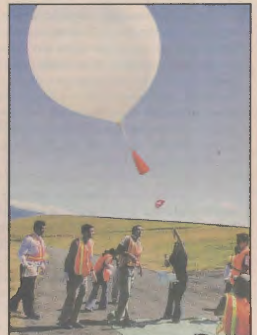
Momento en que se lanza el globo que carga los instrumentos que miden concentración de ozono y vapor de agua.
